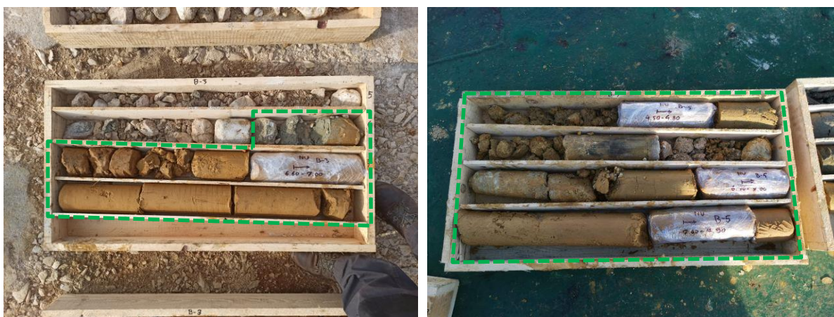
Slika 10. Prikaz potpuno trošnih lapora u sklopu bušotine B-3 (slika lijevo) i bušotine B-5 (slika desno)
