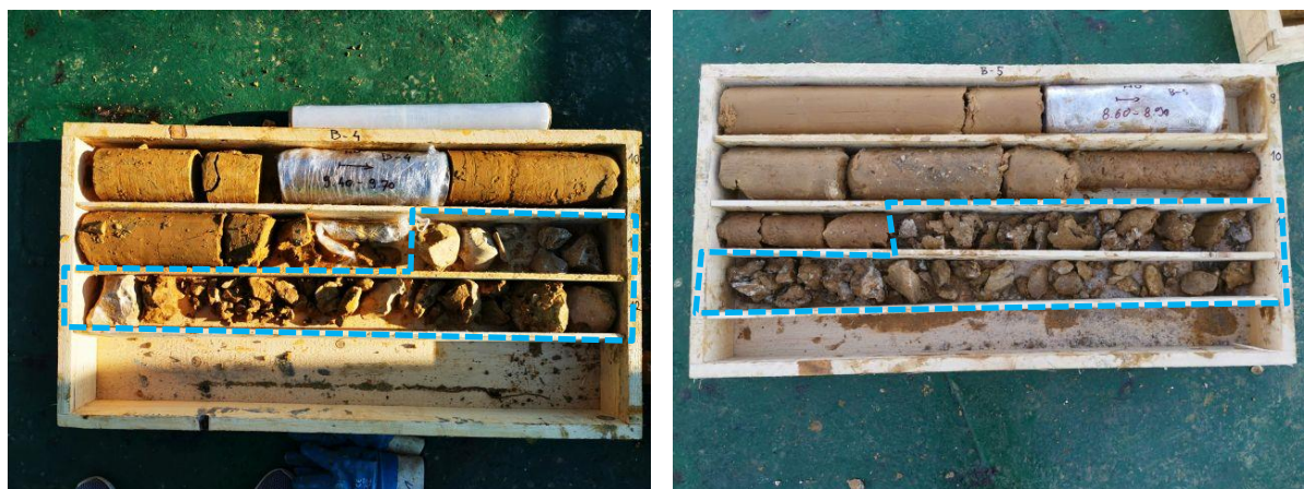
Slika 11. Prikaz visoko do srednje trošnih foraminiferskih vapnenaca u sklopu bušotine B-4 (slika lijevo) i bušotine B-5 (slika desno)
