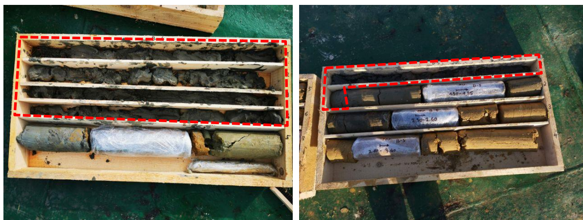
Slika 9. Prikaz naslaga marinskih sedimenata u sklopu bušotine B-4 (slika lijevo) i B-5 (slika desno)
