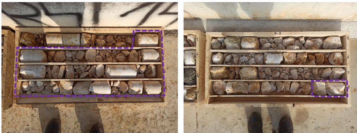
Slika 12. Prikaz srednje do slabo trošnih foraminiferskih vapnenaca u sklopu bušotine B-1 (slika lijevo) i bušotine B-2 (slika desno)
