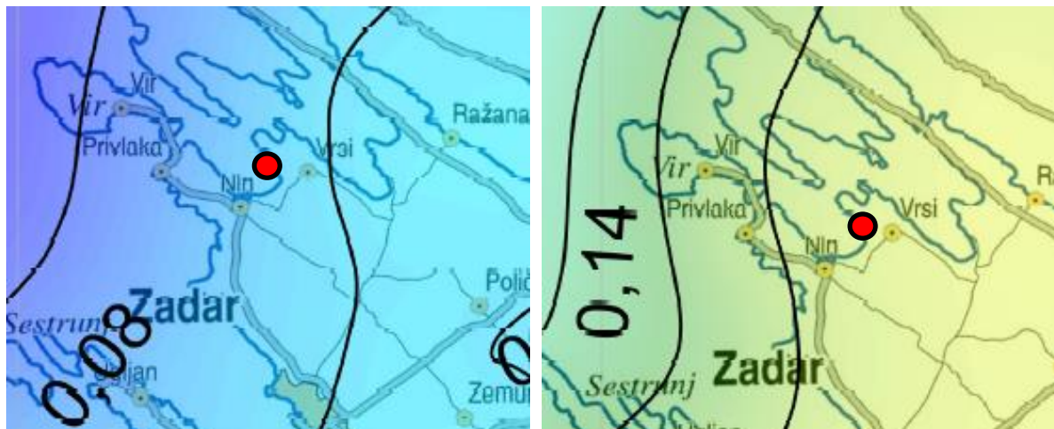
Slika 7. Karta poredbenih vršnih ubrzanja temeljnog tla a_{gR} (temeljno tlo tipa A), s vjerojatnosti prekoračenja 10 % u 10 godina, za poredbeno povratno razdoblje T_{DLR} = 95 god te s vjerojatnosti prekoračenja 10 % u 50 godina, za poredbeno povratno razdoblje T_{NCR} = 475 god. te karta poredbenih vršnih ubrzanja temeljnog tla a_{gR} (temeljno tlo tipa A)
